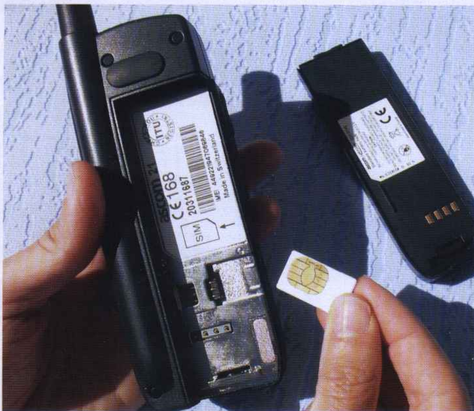
Immer auf Empfang: Wer in Küstennähe ist, wechselt die SIM-Karte am Satelliten-Handy aus. Denn die Geräte können nicht nur übers All, sondern auch über GSM-Netze funken
